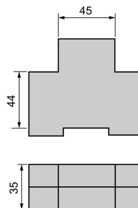
Подходящий автоматический выключатель дифференциального тока (RCBO) для отключения устройств RCBO имеет размеры, указанные на рисунке (в соотв. с DIN 43880). Подойдет любое устройство RCBO с такими размерами.
