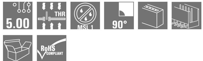
Термостойкий открытый штекерный соединитель угловой конфигурации (90°). Упаковка — коробка или лента. На ленте и с выводами под пайку 1,5 мм оптимизирован для автоматического монтажа. Длина выводов 3,2 мм подходит для пайки волной припоя и оплавлением сквозных отверстий (Reflow). Штекерные соединители обеспечивают место для маркировки и допускают кодирование. HC = высокоточный.
