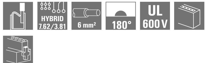
Гнездовой разъем на 180° с контактами питания и сигнальными контактами, подсоединением проводов с применением технологии PUSH IN, шаг 7,62.
