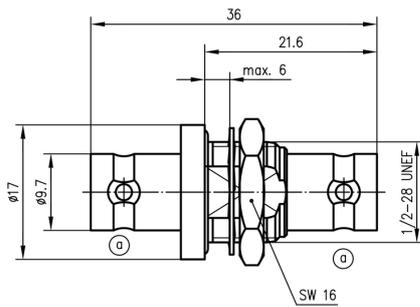
**Разрез узла в сборе**
