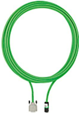
Feedbackkabel für EnDat 2.2; Kabel beidseitig konfektioniert SubD15-Stecker <> con.15 Rundstecker 12-polig SpringTec; geeignet für alle PMC-Servoregler (DD5, protegoD) und den Motoren PM Ctendo SZ.3x; Länge 10m.
