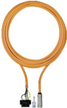
Kabel für PMCprotego und Motor mit Steckerausführung beidseitig konfektioniert mit Stecker <> Rundstecker 8-polig Aderzahl und Querschnitt (4x4 + (2x1,5)) Schleppfähigkeit, Länge 10m.
