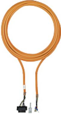
Kabel für PMCprotego und Motor mit Klemmkasten beidseitig konfektioniert mit Stecker <> Ringkabelschuh Aderzahl und Querschnitt (4x1,5 + (2x1,0)) Schleppfähigkeit, Länge 5m.
