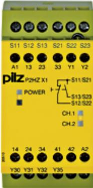
Sicherheitsschaltgerät (standalone), Eingänge: Je 1 S, 1 Ö je Taster, Ausgänge: 3 S, 1 Ö, 2 HL, UB = 115 V AC, Breite: 45 mm, Schraubklemmen integriert, Zweihandbediengerät, Überwachung der Gleichzeitigkeit bei Zweihandtaster.
