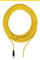
Cable de conexión, PUR, amarillo RAL1003, preparado para cadena dearrastre, 12 polos, conector hembra recto M12, a extremo de cable abierto, código A, longitud del cable: 3 m
