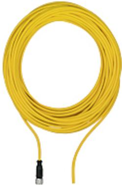
Anschlusskabel, PUR, Gelb, RAL1003, Schleppkettenfähig, 12-polig, Buchse gerade M12, auf offenes Leitungsende, A-kodiert, Kabellänge: 3 m
