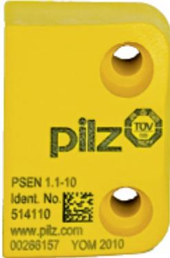
Accionador para interruptor de seguridad magnético, forma rectangular, IP67, distancia de conmutación 3 mm, altura de construcción 13 mm, VP =1 accionador.
