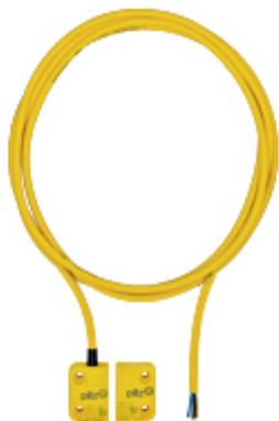
Магнитный защитный датчик 2 н/р, квадратный, высота 13 мм, IP6K9K, расстояние срабатывания 8 мм, для использования с PSEN ix1, комплект поставки = 1 датчик с исполнительным механизмом, с кабелем 5 м (PUR).
