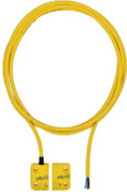
Magnetischer Sicherheitsschalter 2 n/o, rechteckige Bauform, Höhe Bauform 13 mm, IP6K9K, Schaltabstand 8 mm, für Anwendungen mit PSEN ix1, VP = 1 Stück mit Betätiger, mit 5 m Kabel (PUR).
