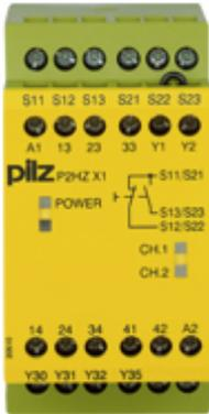
Sicherheitsschaltgerät (standalone), Eingänge: Je 1 S, 1 Ö je Taster, Ausgänge: 3 S, 1 Ö, 2 HL, UB = 24 V AC, Breite: 45 mm, Schraubklemmen integriert, Zweihandbediengerät, Überwachung der Gleichzeitigkeit bei Zweihandtaster.
