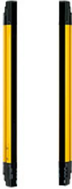
Sicherheitslichtgitter Typ 4, PL e Fingerschutz (Auflösung 14 mm), Schutzfeldhöhe 450 mm. Features: Muting, Blanking, Kaskadierung, Totzonenfreiheit. Programmierung über Software PSENopt Configurator oder direkt am Lichtgitter möglich. Versorgungsspannung 24 V, Anschluss über 18-pol. pigtail-Kabel auf M12-Stecker. Anschlussstecker M12 Sender: 5-polig, Empfänger: Blanking 12-polig, Muting 12-polig/5-polig. Im Lieferumfang sind keine pigtail-Kabel enthalten.
