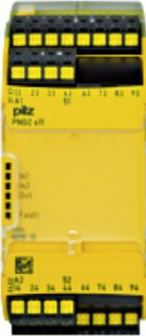
Ampliación de contactos PNOZsigma, salidas: 8 NA, 1 NC, UB = 24 V DC, ancho: 45 mm, bornes de resorte enchufables, bloque de contactos para ampliación junto con partes de controles relativos a la seguridad.
