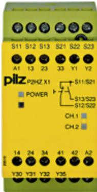
Sicherheitsschaltgerät (standalone), Eingänge: Je 1 S, 1 Ö je Taster, Ausgänge: 3 S, 1 Ö, 2 HL, UB = 110 V AC, Breite: 45 mm, Schraubklemmen integriert, Zweihandbediengerät, Überwachung der Gleichzeitigkeit bei Zweihandtaster.
