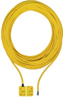
Magnetischer Sicherheitsschalter 2 n/o, rechteckige Bauform, Höhe Bauform 13 mm, IP6K9K, Schaltabstand 8 mm, VP = 1 Stück mit Betätiger, mit 10 m Kabel (PUR).
