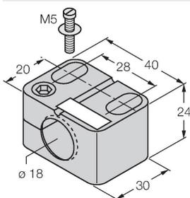
Befestigungsschelle für Gewinderohrsensoren, mit Festanschlag; Werkstoff: PA6
