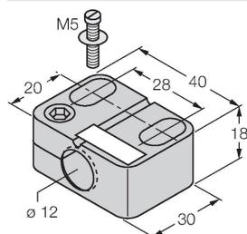
Befestigungsschelle für Gewinderohrsensoren, mit Festanschlag; Werkstoff: PA6
