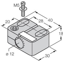
Befestigungsschelle für Gewinderohrsensoren, mit Festanschlag; Werkstoff: PA6
