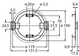
Statorkupplung aus Edelstahl für Hohlwellendrehgeber, Teilkreisdurchmesser 119 mm; für Applikationen mit Axial- und Radialspiel bei hoher Dynamik
