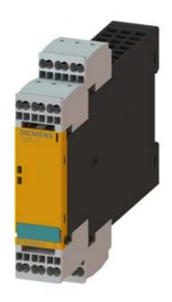
SIRIUS SAFETY RELAY WITH RELAY RELEASE CIRCUITS (FK), 230V AC, 22.5MM, SPRING-LOADED TERMINAL, FK INSTANT.: 4S, FK DELAYED: 0, MC FOR FEEDBACK: 1, EXPANSION UNIT, MAX. ERR. SIL / PL: AS GG,
