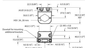
Монтажный кронштейн; ключ переменного размера 24–30 мм; съёмная маркировочная пластина 20 × 9 мм
