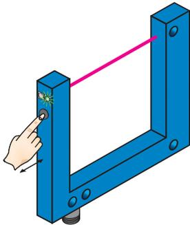
T-Taste 3 - 20 s drücken. Bei gedrückter Taste mehrere Objekte mit Trägermaterial (zu detektierende Objekte) durch den Sensor bewegen. Während des Teach-in Vorgangs blinkt die gelbe LED mit 3Hz. Empfehlung: Mindestens 3 Objekte durch den Sensor bewegen.
