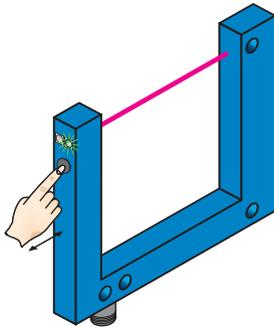
T-Taste 3 - 20 s drücken. Bei gedrückter Taste mehrere Objekte mit Trägermaterial (zu detektierende Objekte) durch den Sensor bewegen. Während des Teach-in Vorgangs blinkt die gelbe LED mit 3Hz. Empfehlung: Mindestens 3 Objekte durch den Sensor bewegen.
