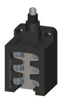
SIRIUS POSITION SWITCH; PLASTIC HOUSING OPEN TYPE 30MM 1NO/2NC SLOW-ACTION CONTACTS WITH OVERLAP METAL PLUNGER,IP10
