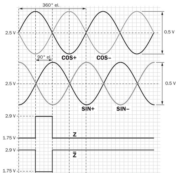
При повороте вала по часовой стрелке, если смотреть в направлении А (см. размерный чертеж)
