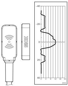
Gesicherter Einschaltabstand  $S_{ao}$  9 mm. Randbereiche bei paralleler Annäherung beachten: Wenn sich der Betätiger seitlich zur Sensorfläche bewegt, muss ein Mindestabstand von 4 mm (typisch) eingehalten werden. Dies verhindert ein zu frühzeitiges Auslösen aufgrund der seitlichen Ansatzbereiche.
