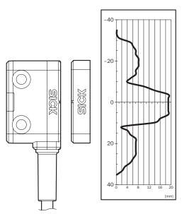
Gesicherter Einschaltabstand  $S_{ao}$  14 mm. Randbereiche bei paralleler Annäherung beachten: Wenn sich der Betätiger seitlich zur Sensorfläche bewegt, muss ein Mindestabstand von 10 mm (typisch) eingehalten werden. Dies verhindert ein zu frühzeitiges Auslösen aufgrund der seitlichen Ansatzbereiche.
