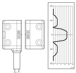
Gesicherter Einschaltabstand  $S_{ao}$  10 mm. Randbereiche bei paralleler Annäherung beachten: Wenn sich der Betätiger seitlich zur Sensorfläche bewegt, muss ein Mindestabstand von 6 mm (typisch) eingehalten werden. Dies verhindert ein zu frühzeitiges Auslösen aufgrund der seitlichen Ansatzbereiche.
