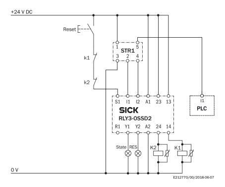
Zwei Transponder-Sicherheitsschalter STR1 in Parallelschaltung an einer Sicherheitssteuerung Flexi Classic
