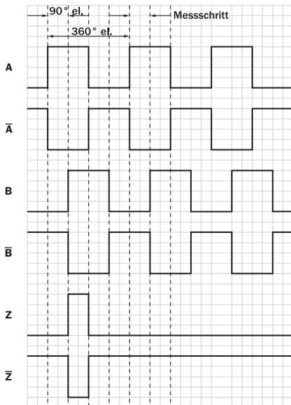
Cw mit Blick auf die Encoderwelle, vergleiche Maßzeichnung. Schnittstellen G, P, R führen nur die Kanäle A, B, Z aus.
