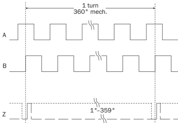
Ширина электрического нулевого импульса 90°, 180° или 270° с возможностью программирования. Ширина нулевого импульса по отношению к периоду повторения импульсов.
