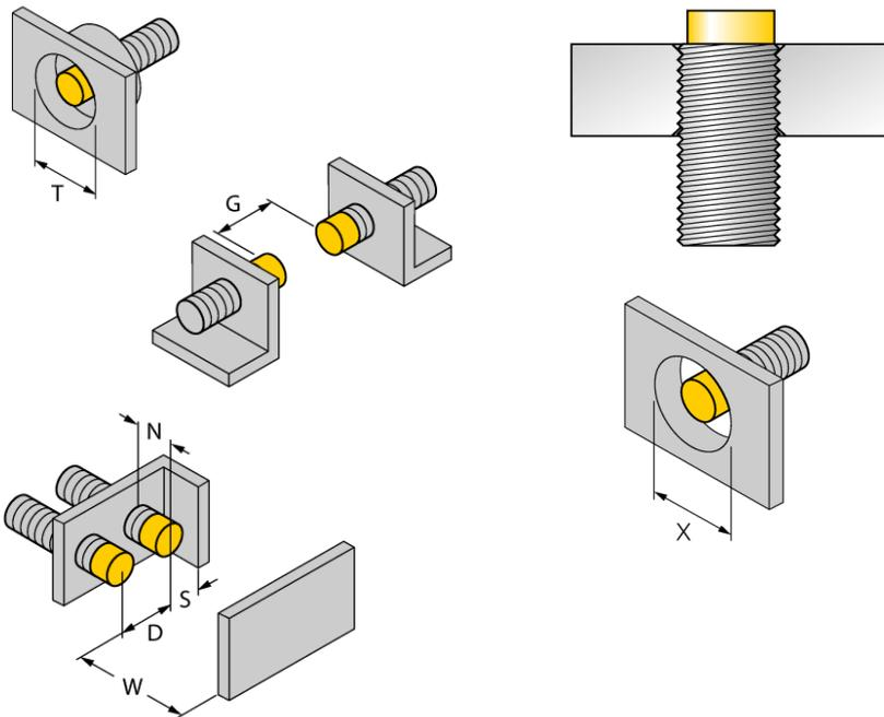
Todos los interruptores de tubo roscado *uprox<sup>+</sup>*, de montaje no enrasado, permiten el montaje hasta el borde del tubo. Por lo tanto la operación segura tiene una reducción máxima garantizada de la distancia de conmutación del 20 %.
