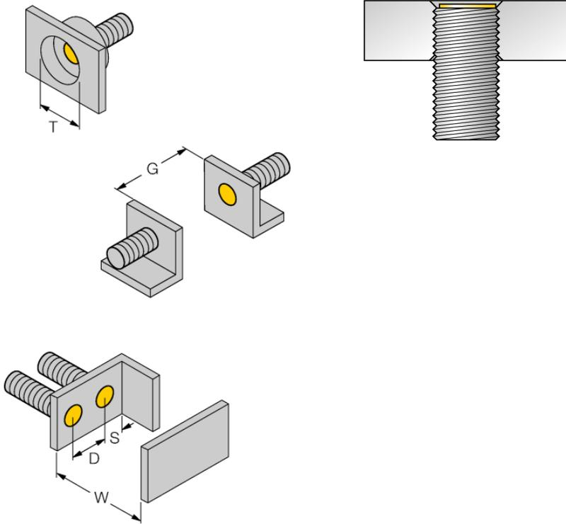
El montaje rebajado es admisible con todos los interruptores de tubo roscado *uprox<sup>+</sup>* de montaje enrasado. Se logra una operación segura cuando se ensambla a media vuelta de la rosca el sensor dentro del material.
