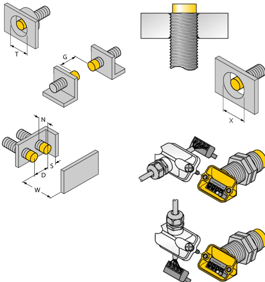
Tous les détecteurs cylindriques non noyables uprox+ permettent un montage jusqu'au bord du tube. Un fonctionnement fiable est ainsi assuré avec une réduction maximale de la portée de 20%.
