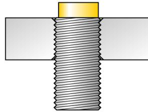
Todos los interruptores de tubo roscado *uprox+*, de montaje no engrasado, permiten el montaje hasta el borde del tubo. Gracias a lo cual se garantiza el funcionamiento seguro con una reducción máxima de la distancia de conmutación.
