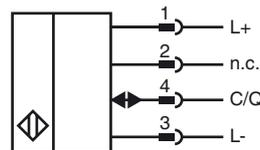
**Elektrischer Anschluss Empfänger**
