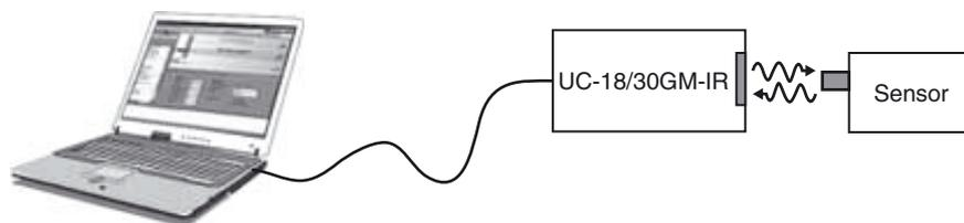
Zur Parametrierung des Sensors wird zusätzlich die Parametriersoftware ULTRA-PROG-IR benötigt. Die Parametriersoftware ULTRA-PROG-IR steht zum kostenlosen Download auf [www.pepperl-fuchs.com](http://www.pepperl-fuchs.com) zur Verfügung. Sie ermöglicht die Einstellung aller freien Parameter, wie z.B.:
