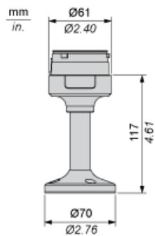
Montage einer modularen Signalsäule
