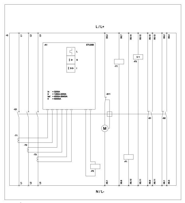
L (Long Time Delay / Überlastschutz); S (Short Time Delay / Kurzachlussschutz, kurzzeitvezzögert); I (Instantaneous / Kurzachlussschutz, unverzögert); S11 (Internal motor shutdown switch, if spring is tensioned / Interner Motorabstellschalter, wenn Foder gespannt); F1 (1st suziliary release / Erster Hilfssuslöser); F3 (Undervoltage release / Unterspannungssuslöser); F3 (Maglatch for trip unit / Auslösemagnet); S1 - S8 (Auxiliary switch / Hilfsschalter); Y1 (Closing coil / Einschaltmagnet);
