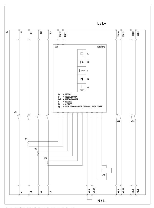
L (Long Time Delay / Überlastschutz); S (Short Time Delay / Kurzschlussschutz, kurzzeitverzögert);
