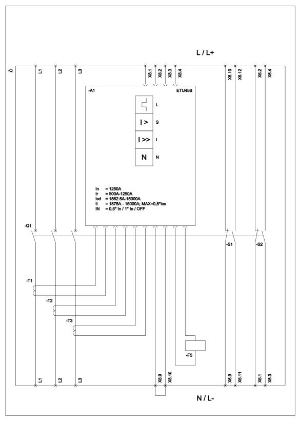
L (Long Time Delay / Überlastschutz); S (Short Time Delay / Kurzschlus sschutz, kurzzeitverzögert);
