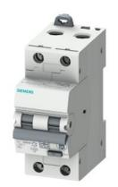
RCBO, 10 kA, 2P Type A, 30 mA, C-Char, In: 32A Un: 230V
