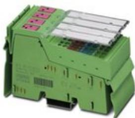
Inline, Digitalausgabeklemme, Digitale Ausgänge: 8, 24 V DC, 2 A, Anschlusstechnik: 4-Leiter, Übertragungsgeschwindigkeit im Lokalbus: 500 kBit/s, Schutzart: IP20, inklusive Inline-Steckern und Beschriftungsfeldern
