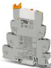
PLC-INTERFACE, bestehend aus Grundklemme PLC-BSC.../21 mit Schraubanschluss und steckbarem Miniaturrelais mit Mehrlagen-Goldkontakt und Handbetätigung, 1 Wechsler, Eingangsspannung 24 V DC
