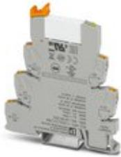
PLC-INTERFACE für Bahnanwendungen, bestehend aus Grundklemme mit Push-in-Anschluss und steckbarem Miniaturrelais mit Leistungskontakt, Bereich:  $0,7 \times U_N$  bis  $1,25 \times U_N$ , Temperaturklasse TX:  $-40 \text{ }^\circ\text{C}$  bis  $+70 \text{ }^\circ\text{C}$ , 1 Wechsler, Eingangsspannung 110 V DC
